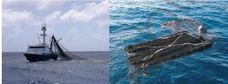
Gambar. 4.6. Sebuah Kapal Tuna Purse Seiner dengan Benda Terapung ( drifting floating objects ) yang Dilengkapi dengan Radio atau Satelit Beacons Sehingga Dapat Di-tracking Posisi Benda Tersebut di Atas Kapal (Dagorn et al. , 2003).
